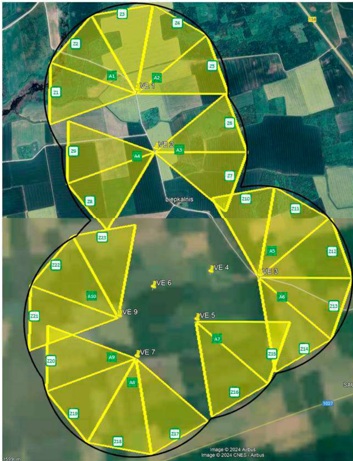
2 priedas. Akmenės VE parke įrengtų AVES Wind ACS (Anti-Collision System) sistemų (ProTecBird GmbH) schema
